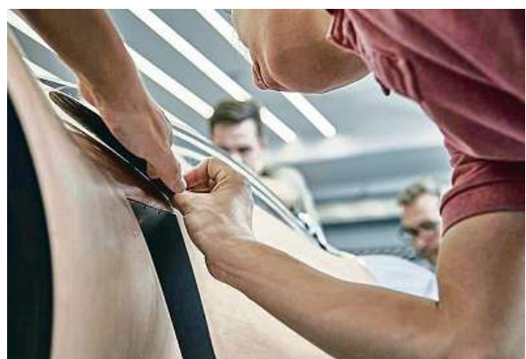
MODELÁŘI SPECIALISTÉ AUFEER DESIGN PRACUJÍ NA TAKZVANÉM CLAY MODELINGU, TEDY PŘIPRAVĚ HLINĚNÉHO MODELU PROTOTYPU VOZU.
